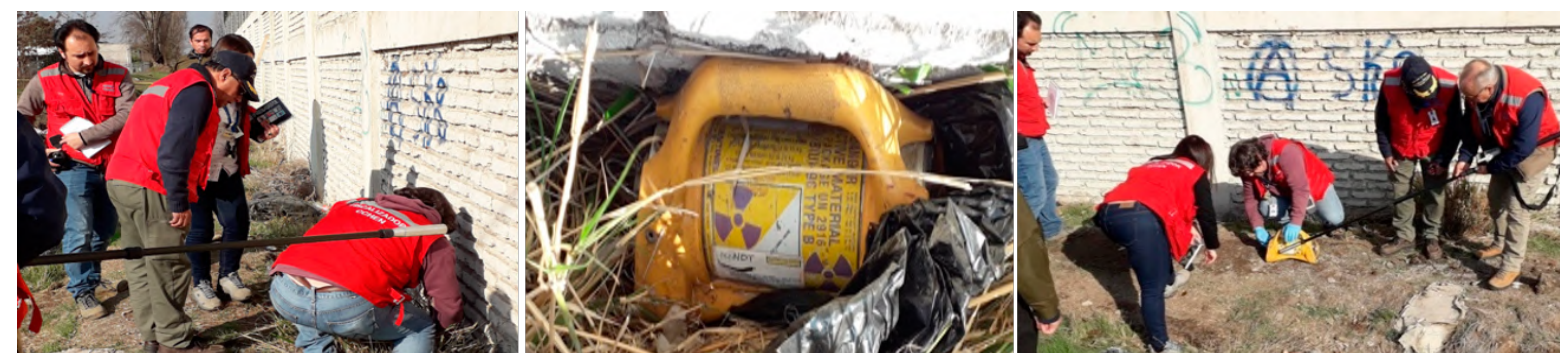
Imagen N° 22: evaluación radiológica durante rescate de equipo de gammagrafía industrial.
