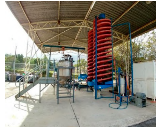
Imagen N° 7: espiral Humphrey's, utilizado en la pre-concentración gravitacional de minerales.
