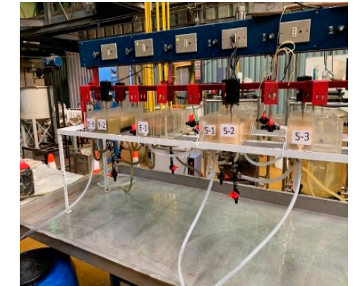
Imagen N° 9: planta de Extracción por Solventes para concentrar y purificar ETR.
