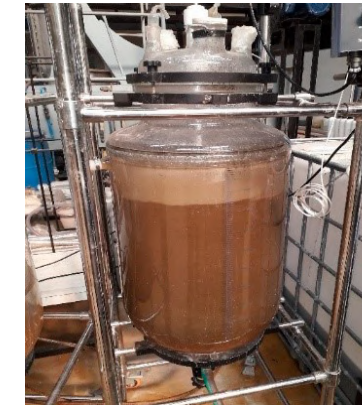
Imagen N° 8: lixiviación minerales portadores de ETR en reactor de vidrio.
