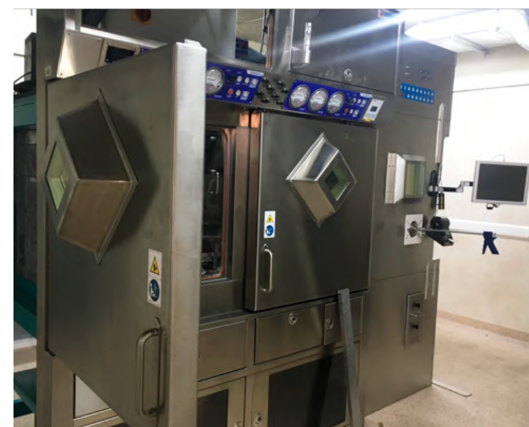
Imagen N° 19: las dos primeras celdas (de izq a der) son de síntesis, y la tercera, de fraccionamiento.
