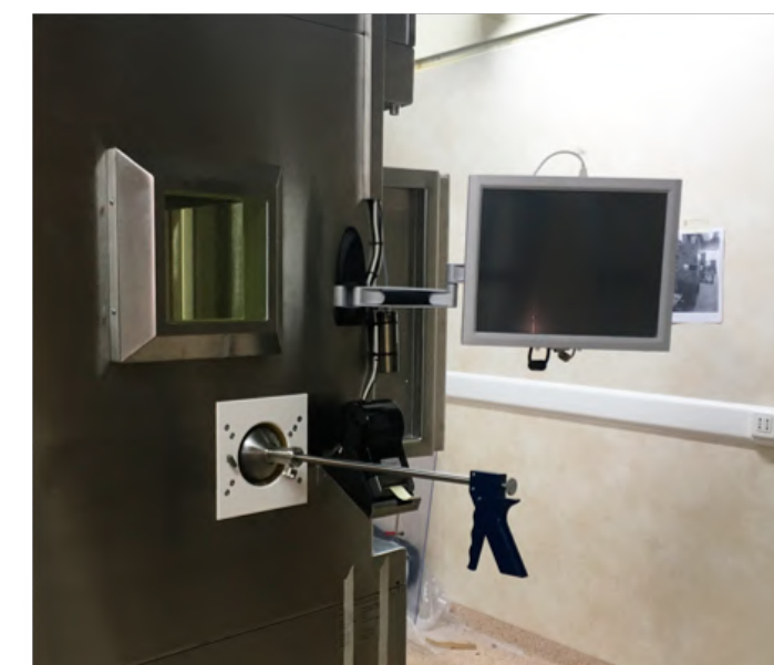
Imagen N° 19: las dos primeras celdas (de izq a der) son de síntesis, y la tercera, de fraccionamiento.
