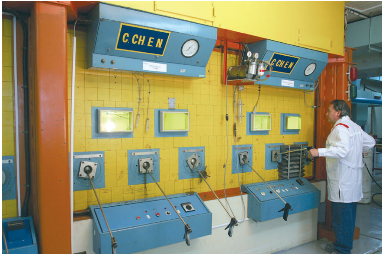
Celda de producción para fabricación de Yodo 131 y Tecnecio 99m
