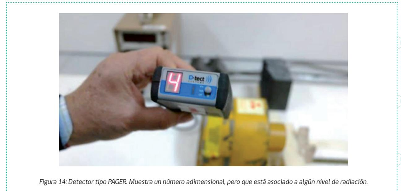
Figura 14: Detector tipo PAGER. Muestra un número adimensional, pero que está asociado a algún nivel de radiación.
