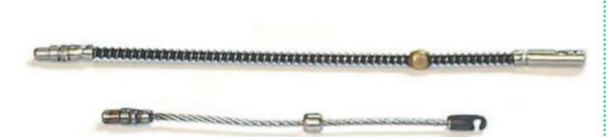
Figura 3: Fuentes de Iridio 192 utilizadas en gammagrafía industrial.
