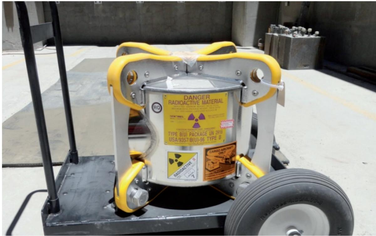
Figura 15: Equipo usado en minería de gammagrafía industrial.
