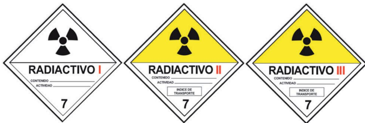
Figura 10: Tipos de etiquetas utilizadas en los bultos con material radiactivo.
