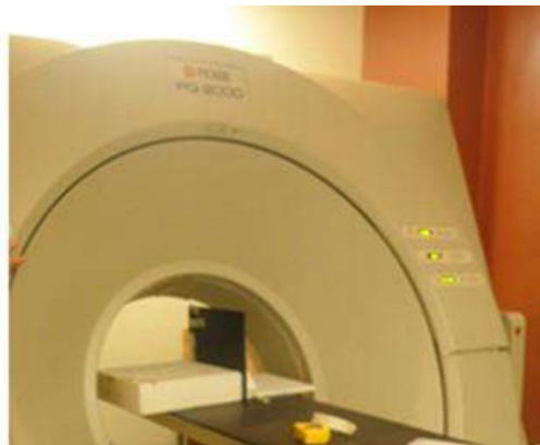
FIG. 49. Posicionamiento de la película para verificación de la inclinación del gantry.
