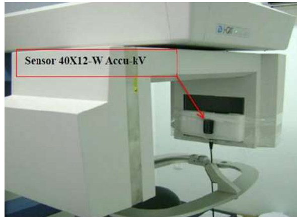
FIG. 27. Imagen del posicionamiento del medidor de tensión no invasivo en el equipo de CBCT para la medición del kVp.
