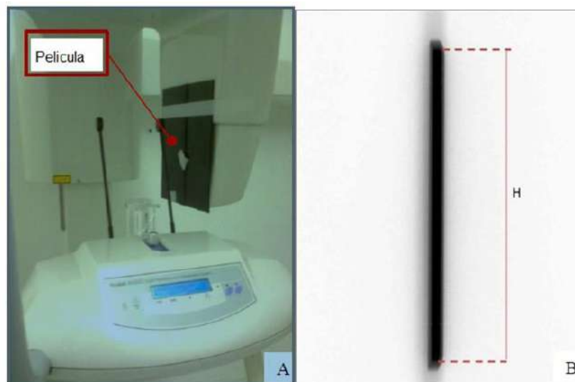
FIG. 23. (a) Posicionamiento de la película delante del colimador secundario (receptor de imagen), (b) Imagen del haz después de la ranura.
