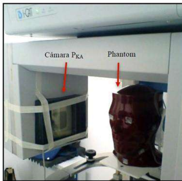
FIG. 33. Imagen de posicionamiento de la cámara P_{KA} en el equipo CBCT con un maniquí antropomórfico para simular el paciente.
