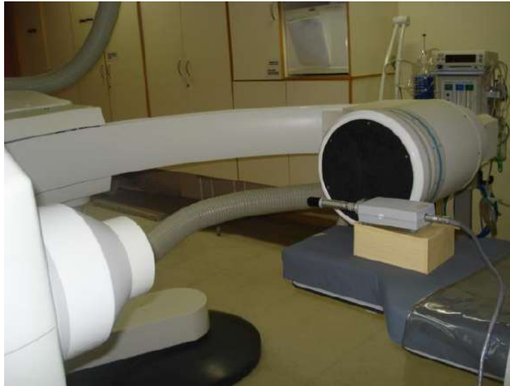
FIG. 37. Configuración para medir el rendimiento.
