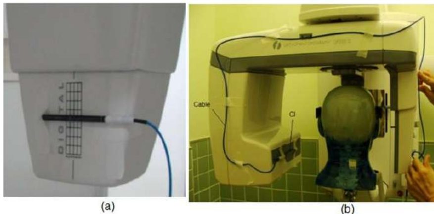
FIG. 25. (a) Imagen de la cámara lápiz posicionada en el colimador secundario (b) posicionamiento del fantoma y del cable para evitar que se enrolle.
