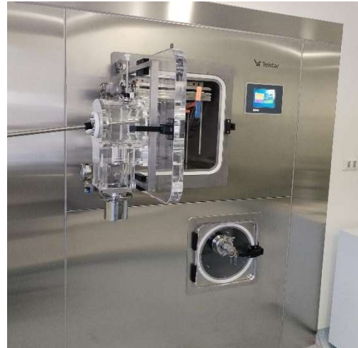
Foto 2: Nuevo Liofilizador LyoBeta 3PS Telstar, instalado con configuración de área limpia en Laboratorio de Liofilizados CCHEN.
