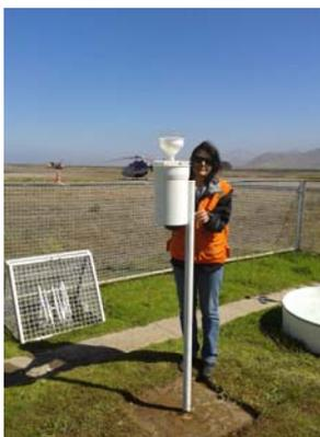
Fig 1. Colector instalado en patio de instrumentos de la Dirección Meteorológica, aeropuerto La Florida La Serena
