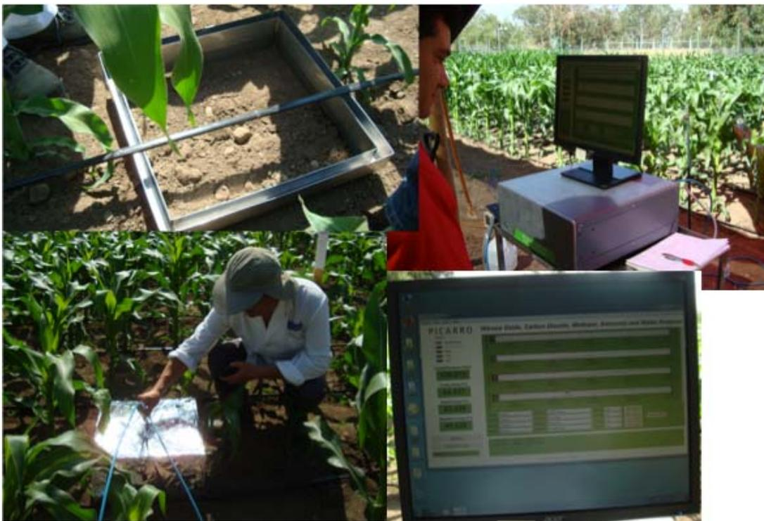
Figura 1. Marco de acero inoxidable instalado en el sitio de estudio, cámara de toma de muestras, equipo PICARRO.
