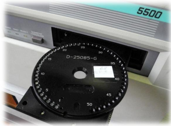
Fig. 2. Carga de disco con elementos termoluminiscentes al lector Harshaw 5500.
