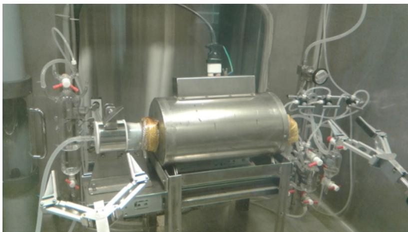
**Fotografía 1:** Celda de Producción de  $^{131}\text{I}$ , vía destilación seca.
