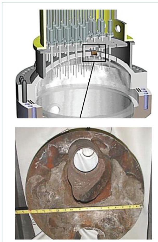
**Ilustración 11: Arriba se aprecia la localización del punto degradado de la tapa de la vasija. Abajo se aprecia el agujero causado por la corrosión por ácido bórico en la tapa. Fuente: (58)**
