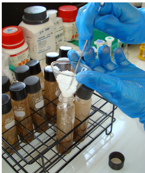
Metodología de extracción QUECHERS para plaguicidas en suelo.
