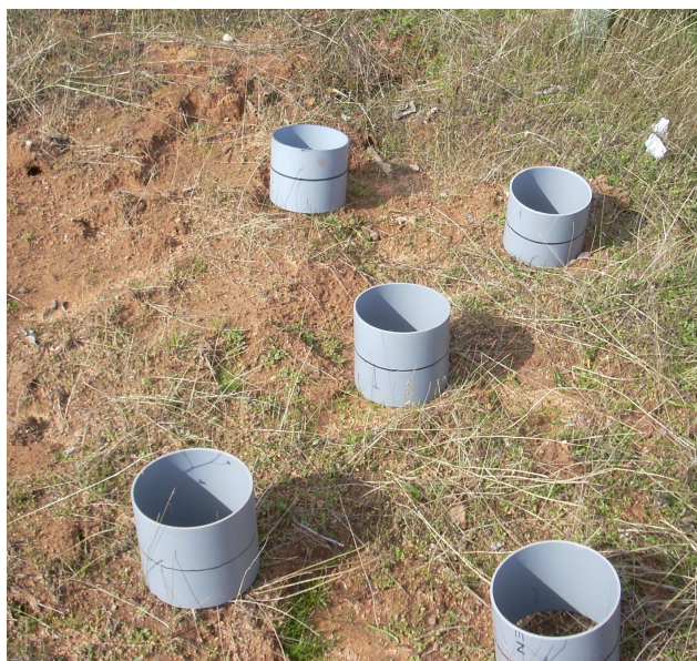
Método de muestreo de suelo (no disturbador) para medición de erosión y movimiento de nutrientes y pesticidas asociado al suelo.
